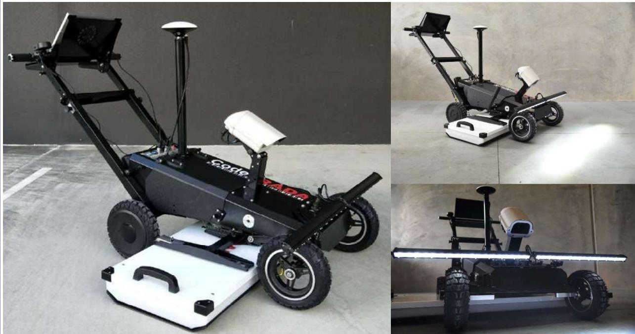
多チャンネルスキッド型 3D GPR システム(Model LYNX)は、1.2m 幅のスキッド型ケースに複数の 2 極性型の送/受信アンテナを配置し、3D 探査に向けた地下レーダー装置で、多チャンネルのレーダーデータを同時に記録、表示するシステムです。
